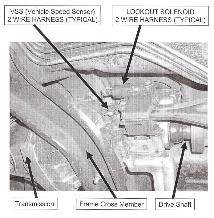
LOCKOUT SOLENOID 2 WIRE HARNESS (TYPICAL)
